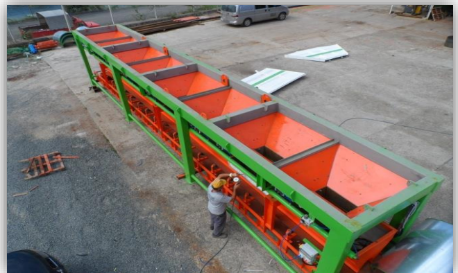
(02) – 4 x 20 მ 3 ნედლეულის ბუნკერის ქვედა სასწორი ლენტა ( LOAD CELL)
