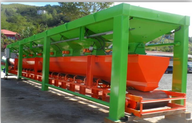
(02) – 4 x 20 მ 3 ნედლეულის ბუნკერის ქვედა სასწორი ლენტა ( LOAD CELL)
